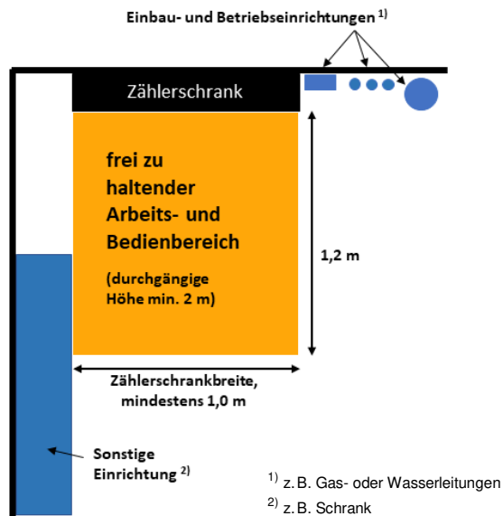
Abbildung 3: Arbeits- und Bedienbereich vor dem Zählerschrank
